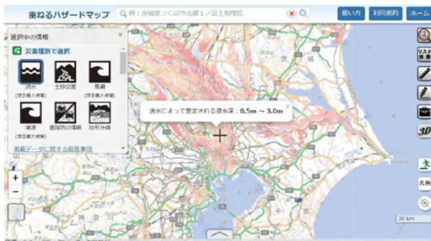
図4 ハザードマップポータル（国土交通省） パレット PNG を使ってクリック位置の凡例を表示 https://disaportal.gsi.go.jp
